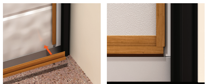
Устанавливаем нижний профиль для облицовки в стык с нижним профилем ворот, соблюдая технологический зазор в 1 мм до боковой крышки с каждой стороны
